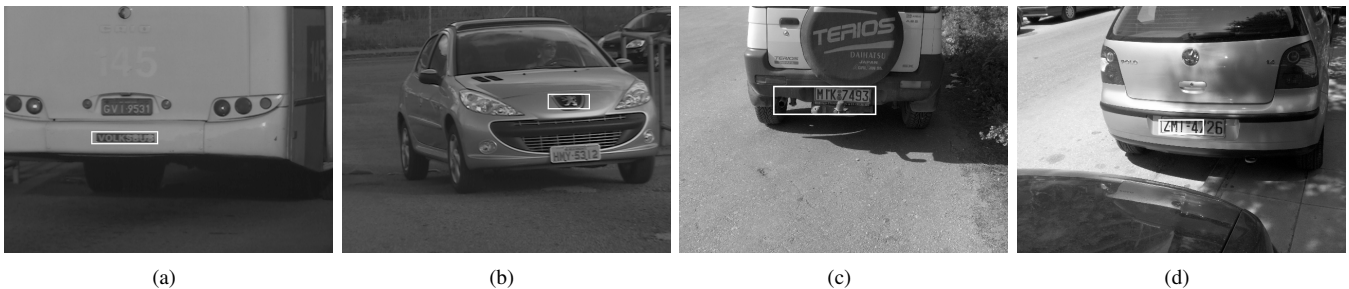
Figura 4. Exemplos de erros na localização da PIV: (a) Localização da marca do veículo; (b) Localização do símbolo da marca; (c) Localização de região extra; (d) Localização de somente parte da PIV.
