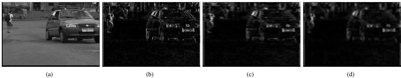
Figura 2. Etapas do método de localização de PIVs: (a) Imagem original; (b) Gradiente vertical; (c) Aplicação do filtro da média; (d) Saliências pequenas ofuscadas.
